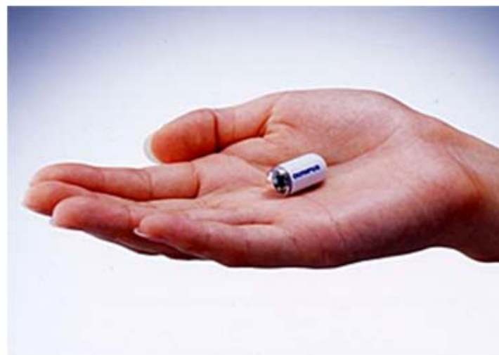
観察専用の受動型カプセル内視鏡の外観
