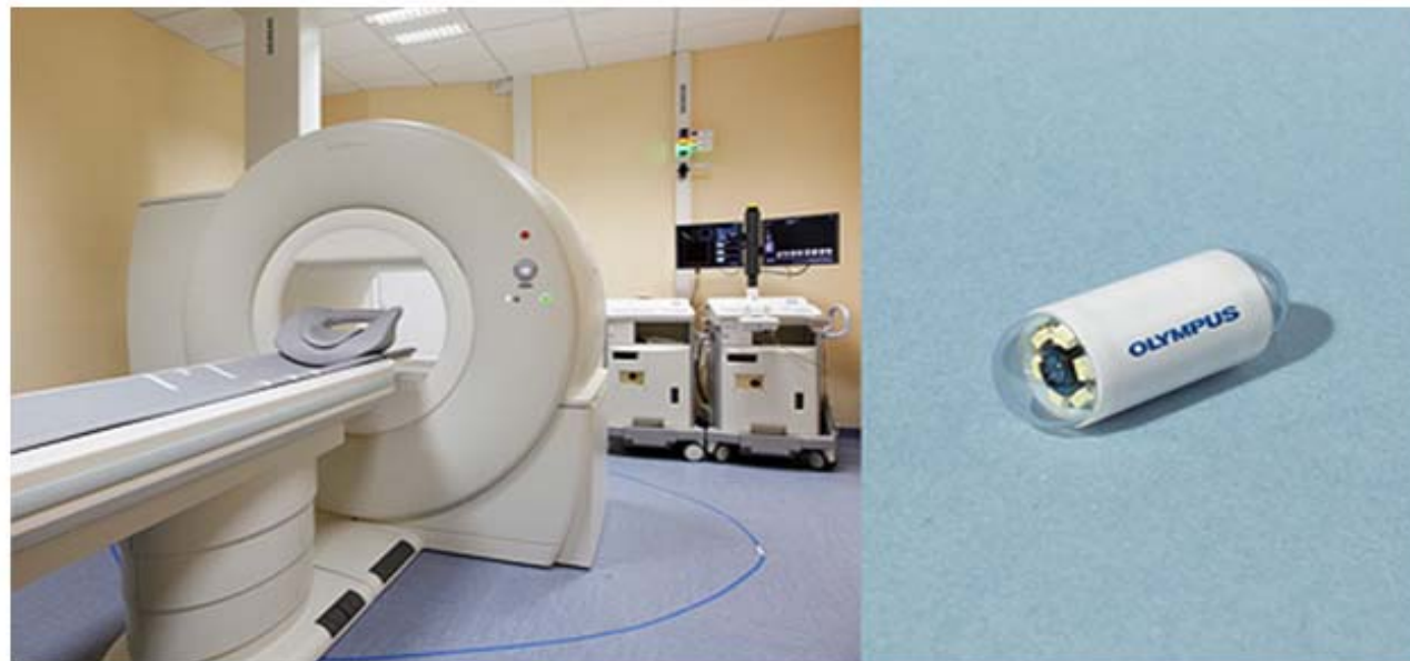
「磁気誘導装置システム」「画像・誘導情報システム」と「カプセル内視鏡」の試作機
